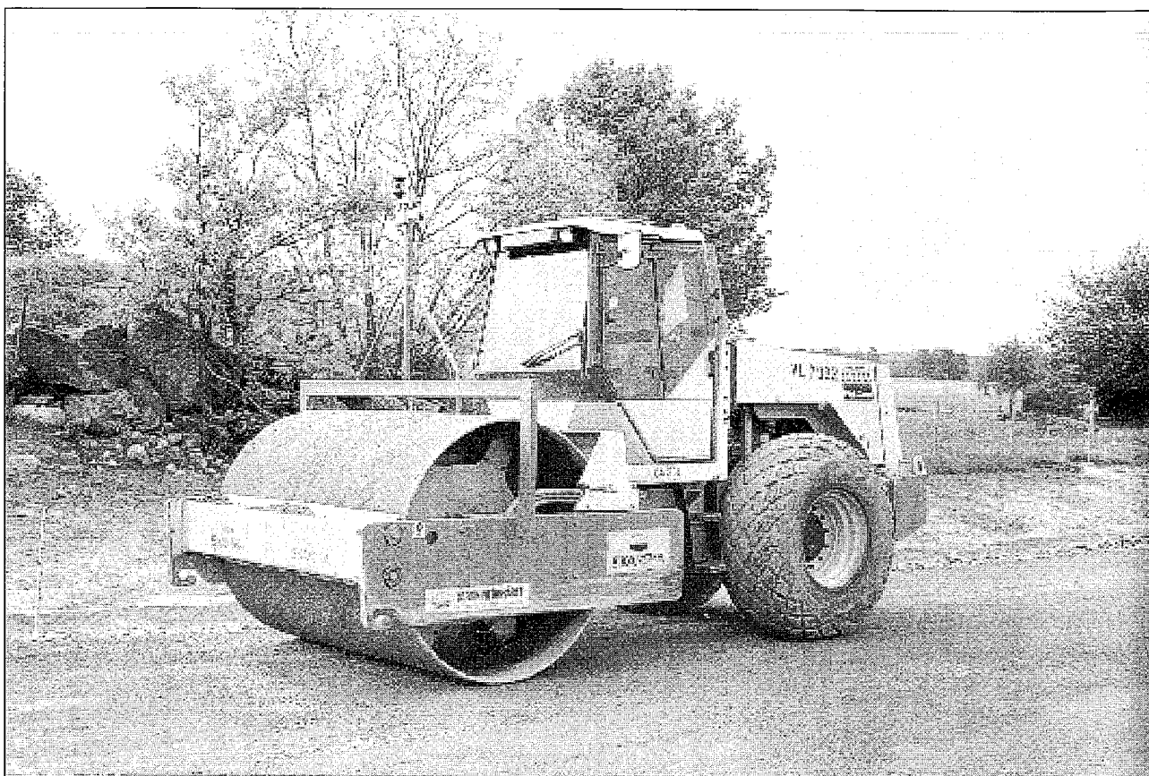
Självgående vält med prismahållare för yttäckande nivåkontroll
